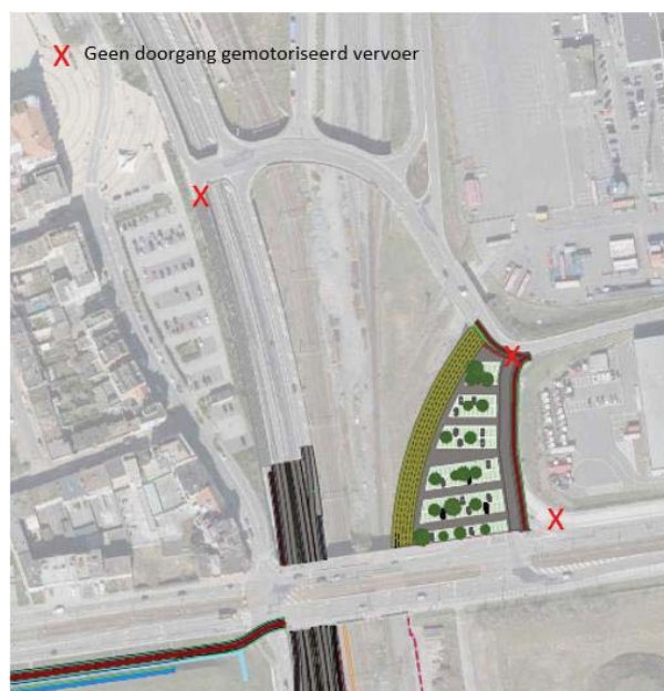
Figuur 3.12: Weergave rechts: aansluiting van de New Yorklaan met de N34 (wordt geknipt voor het reguliere verkeer). Eveneens wordt de westelijke ventweg gesloten voor gemotoriseerd verkeer (links).
