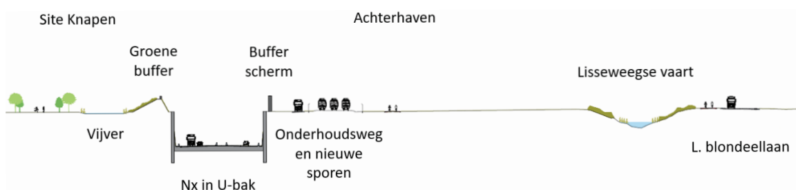
Figuur 3.5: Dwarsdoorsnede 7 – Site Knapen met weergave van de Nx in open U-bak en nieuwe sporen
