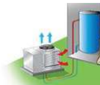
Figuur 194: Schematische voorstelling van een lucht/water koude-opwekker
