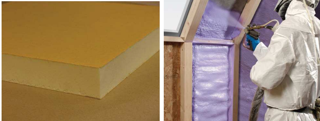
Figuur 109: PUR/PIR: platen (links) en ingespoten (rechts)
