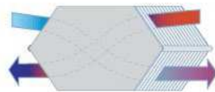
Figuur 227: Principe van warmterecuperatie
