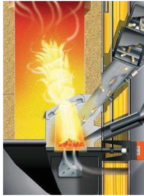
Figuur 161: Branderpot van een pelletkachel
