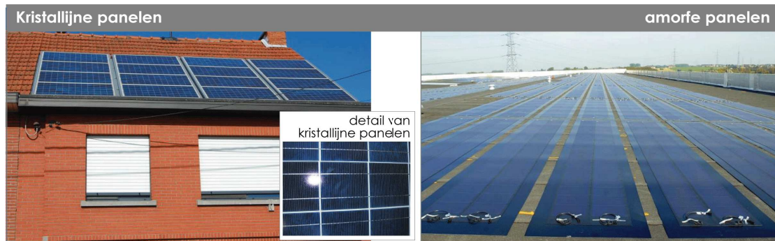
Figuur 242: Kristallijne panelen (links) en amorfe panelen (rechts)
