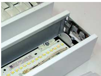
Figuur 82: Niet-vervangbare LED-chips in een verlichtingsarmatuur
