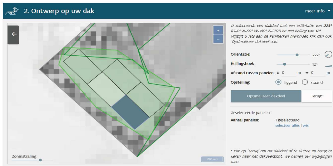
Figuur 236: Aanpassen ontwerp installatie in de zonnekaart en weergeven oriëntatie van de panelen
