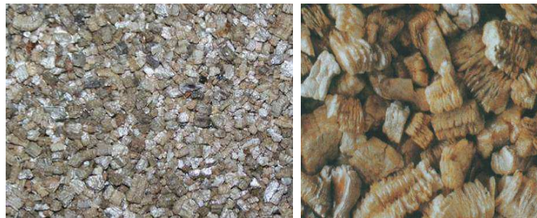
Figuur 112: Vermiculiet: platen (links) en korrels (rechts)
