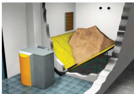
Pelletopslag in een silo met aanzuigsysteem
