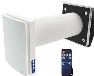
Figuur 229: Decentraal mechanisch ventilatietoestel voor plaatsing in een buitenmuur, alternerend toevoer en afvoer, met warmterecuperatie.
