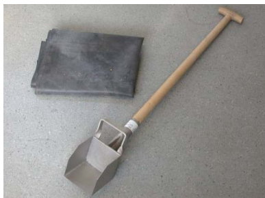
Figuur 1: bemonsteringsschep met rechtopstaande rand
