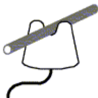
Figuur 5.24. Plaatsingswijzen van elektrische leidingen – Op isolatoren
