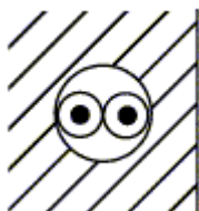
Figuur 5.22. Plaatsingswijzen van elektrische leidingen – Rechtstreeks verzonken, zonder buizen
